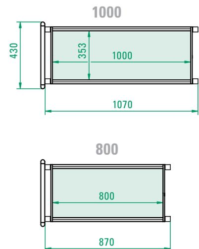
FAMA Rollschränke sind alternativ auch in der Abmessung 612,5 x 1070 mm erhältlich. Ebenso sind Tandem-Rollschrankanlagen möglich.
